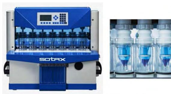
Figura 22 Aparato IV (celda de flujo continuo)
