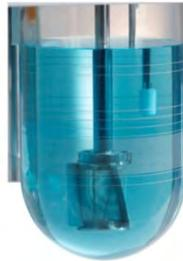
Figura 17 Aparato de disolución I (Aparato de canastilla)
