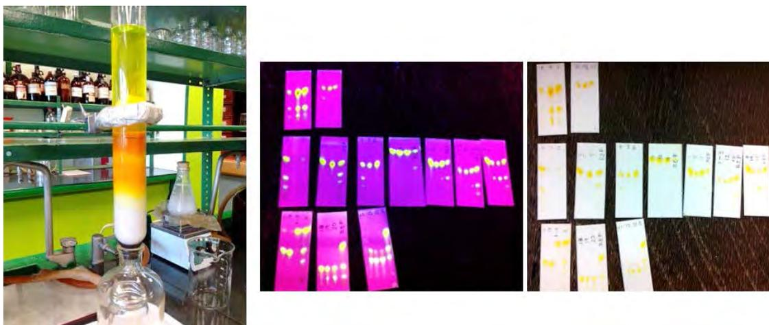
Figura 35 Cromatografía preparativa de curcuminoides eficiente (izq.) y seguimiento de la elución mediante cromatoplacas con detección UV a 365nm (centro) y a simple vista (der.)
