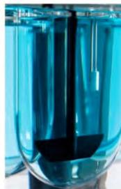
Figura 19 Aparato de disolución II (Aparato de paletas)
