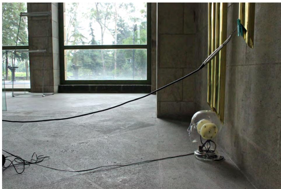
*Detalle de Dummy Head (Cabeza con micrófonos de condensador, grabación binaural) y micrófono de contacto tensado a uno de los tubos metálicos de la instalación.*
