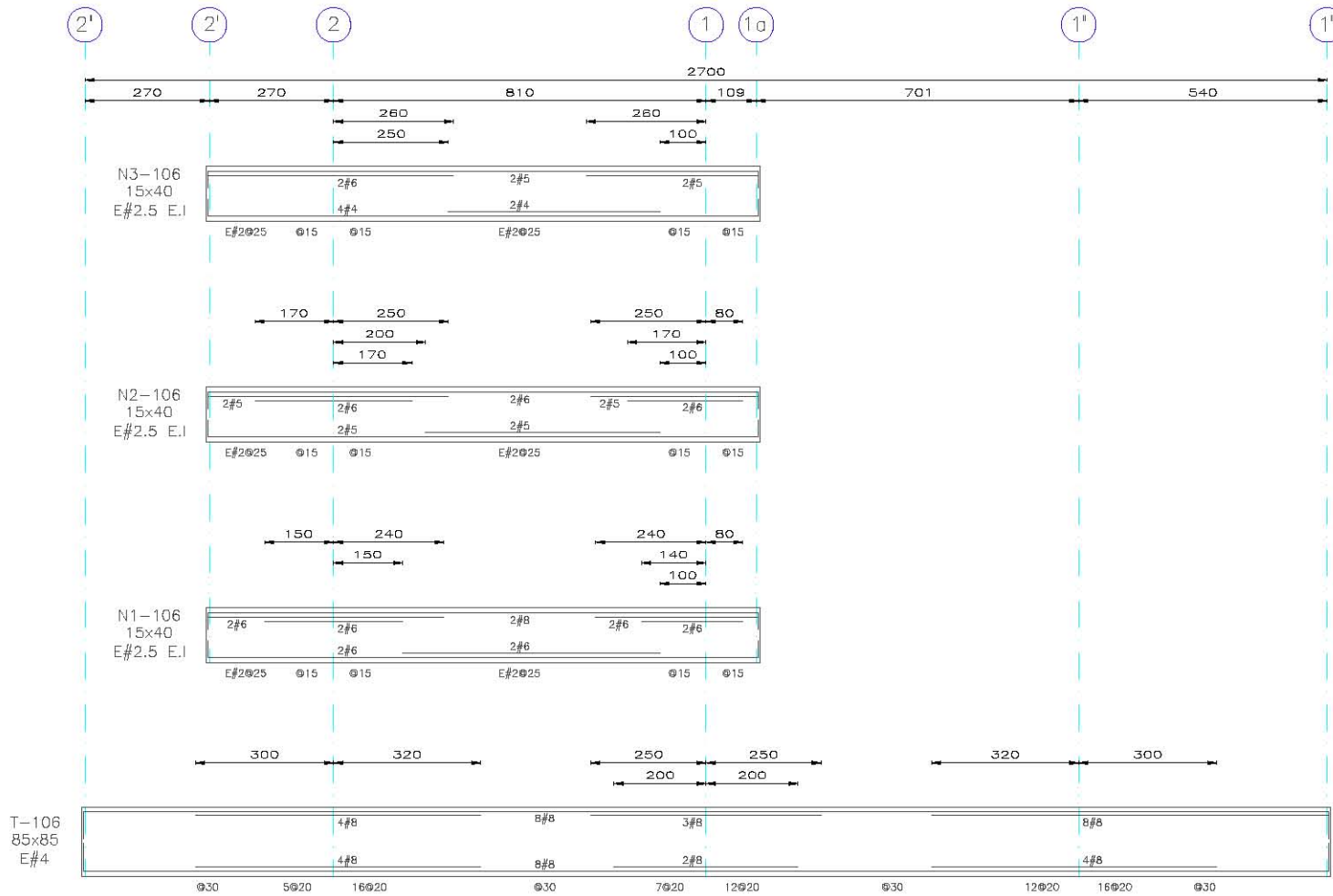
FIG. 2.32 ARMADO DE NERVADURAS Y TRABE, MARCO EJE E
