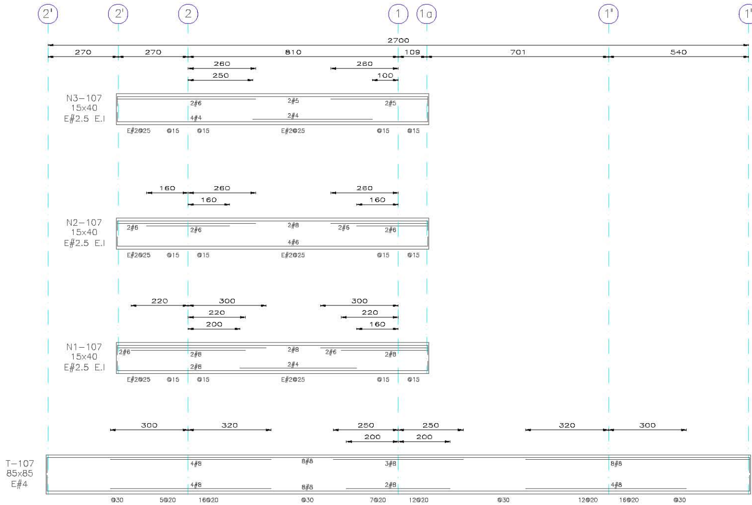
FIG. 2.33 ARMADO DE NERVADURAS Y TRABE, MARCO EJE F
