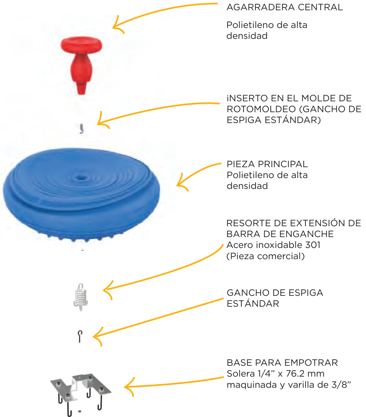
Esquema 24 Acevedo, TM (2017) Esquema explosivo de las piezas que conforman el diseño final.
