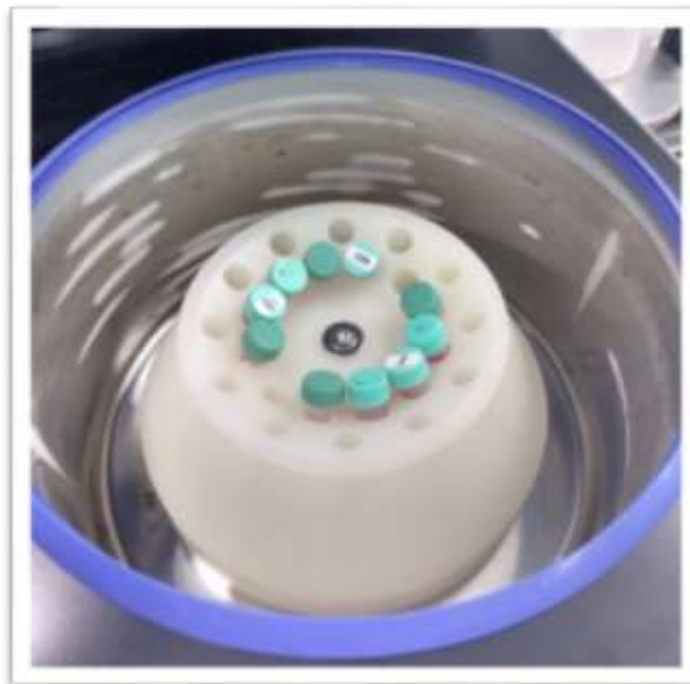
Figura 4. Centrifuga refrigerada con muestras para la determinación de CRA
