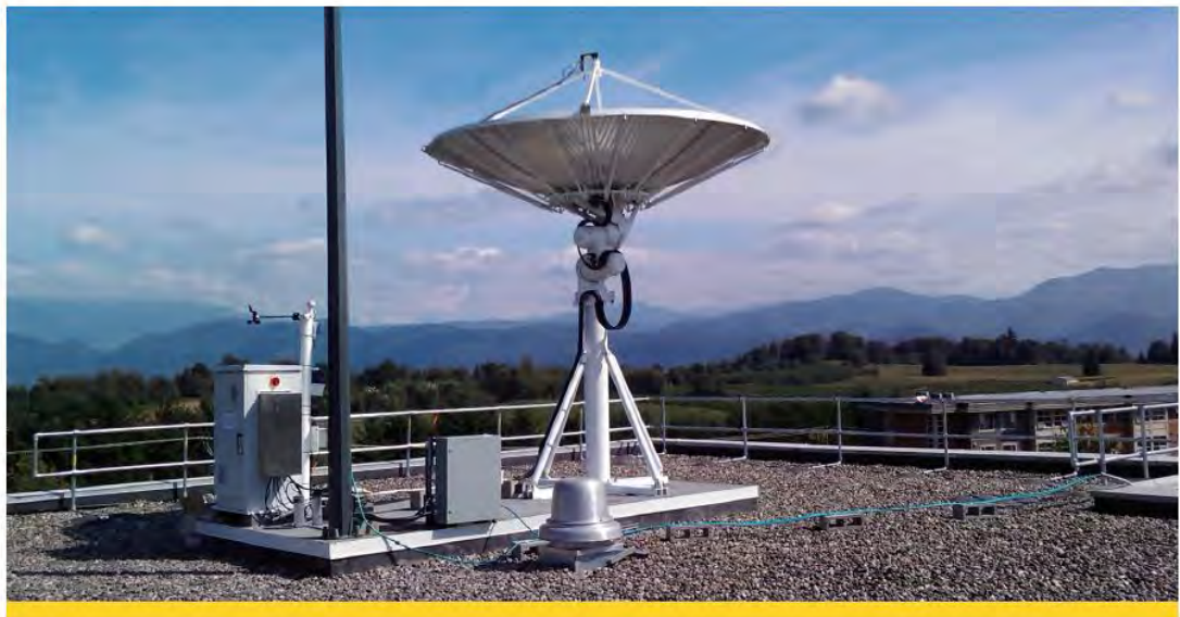
Figura 5.4. Antena para telemetría, rastreo y comando (TT&C) de la empresa TeleCommunication Systems
