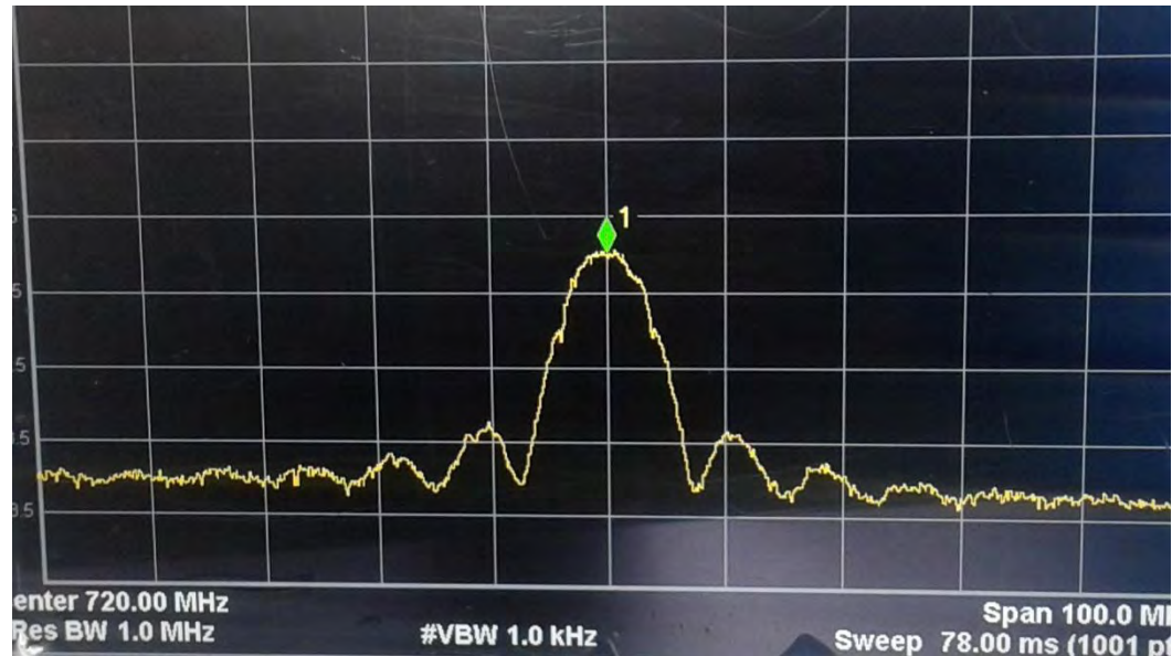
Figura 5.25 Portadora de un satélite en frecuencia intermedia de 720 MHz
