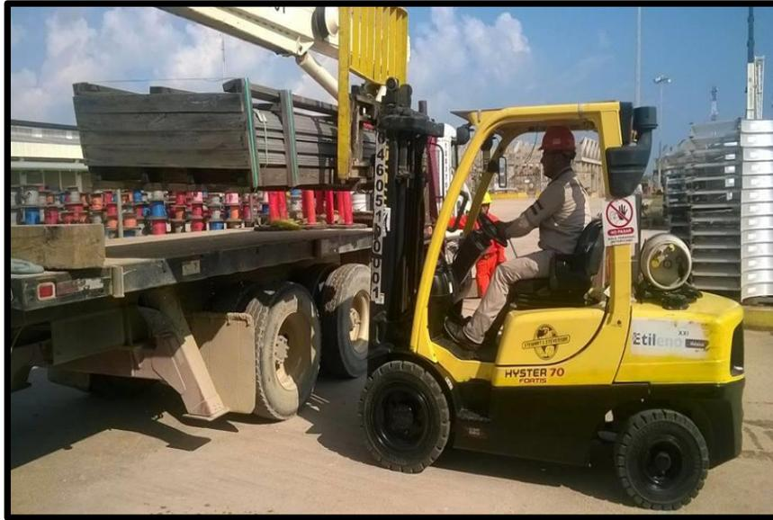
**Figura 25.** Montacargas clase 3.
