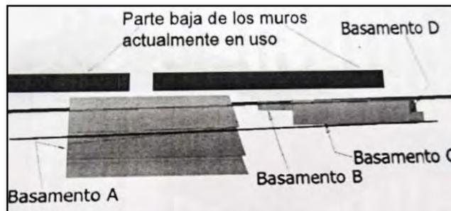
Figura 4. Vista en corte del conjunto de basamentos, donde se puede observar la profundidad y las sobreposiciones de cada un de los basamentos. (Islas y Barrera, 2010)
