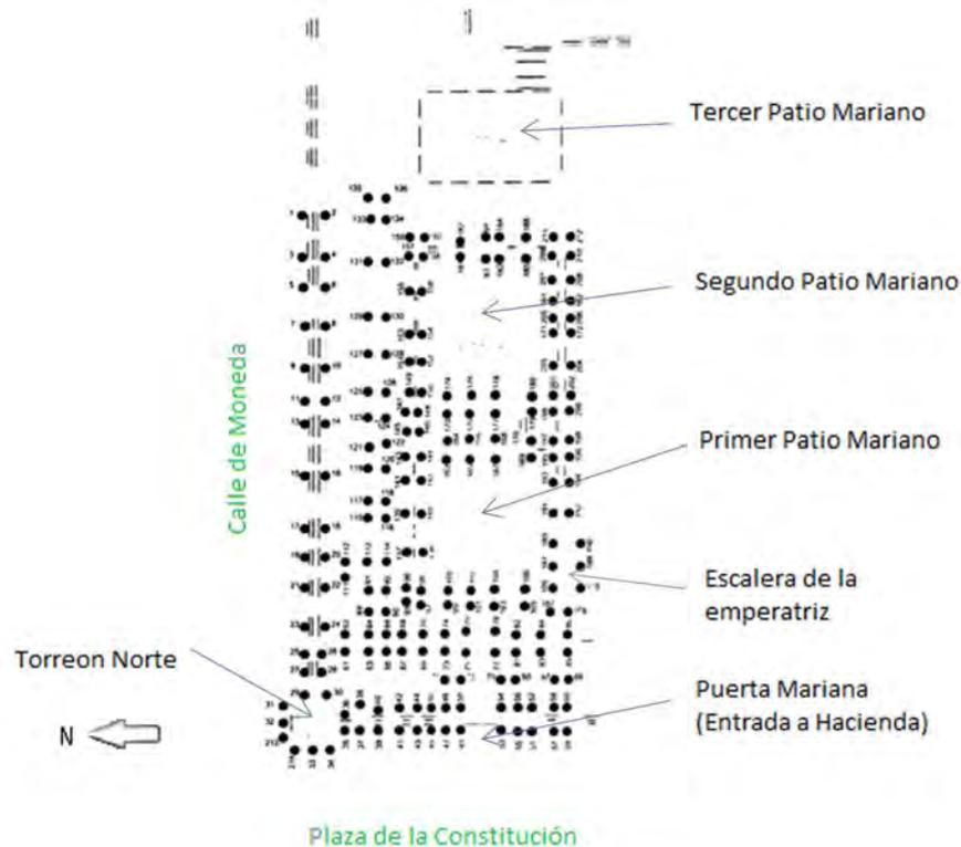
Figura 97. Localización de los pilotes de control instalados en el Palacio Nacional. (Terrones, 2001).
