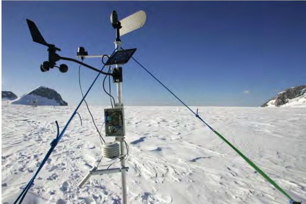
Imagen 14. Nodo con sensores para medir la temperatura de la superficie, la temperatura del aire y la humedad en los Alpes Suizos.
