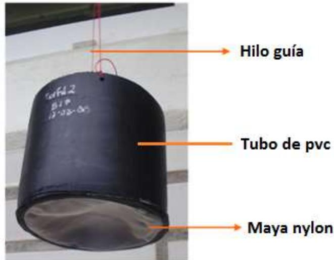
Figura 13. Contenedor de resinas de intercambio iónico, tomado de Díaz (2011).
