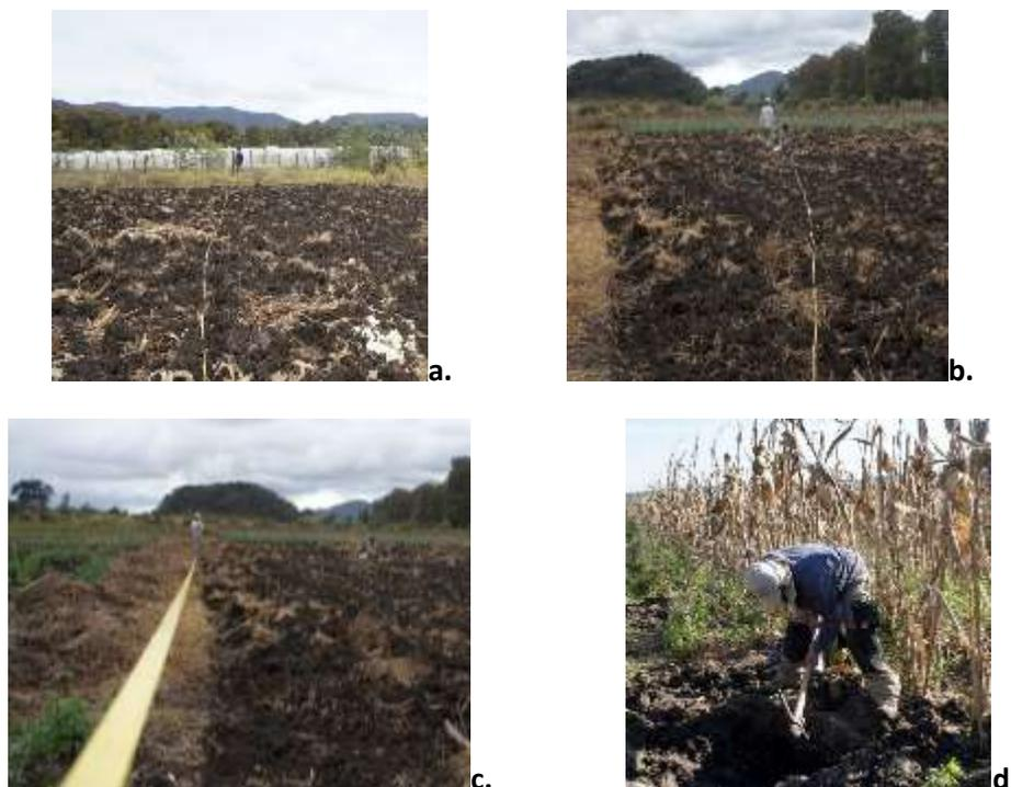
Figura 17. **a, b y c** Triangulación para localizar el sitio de los contenedores de resinas de intercambio iónico después del periodo de instalación, **d.** búsqueda de los hilos guía y de los contenedores.
