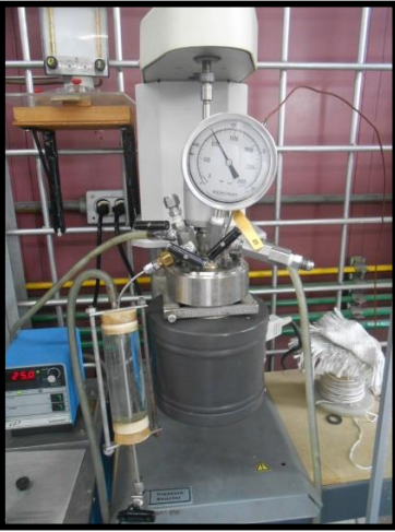
Figura 28. Reactor por lotes utilizado para la hidrosulfuración de dibenzotiofeno. Con la información conseguida del cromatógrafo, se identificó el reactante y los productos involucrados en la reacción de HDS del compuesto DBT; en la Tabla VII se ilustran estas especies químicas.
