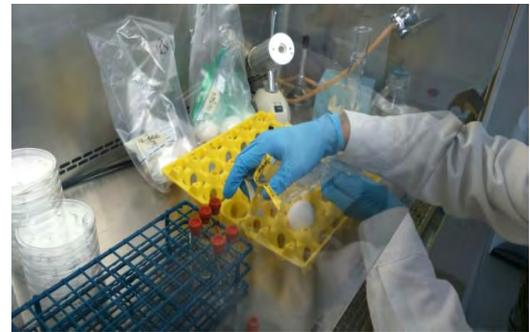
Imagen 14 Vaciado de la muestra a un tubo de 16 x 100
