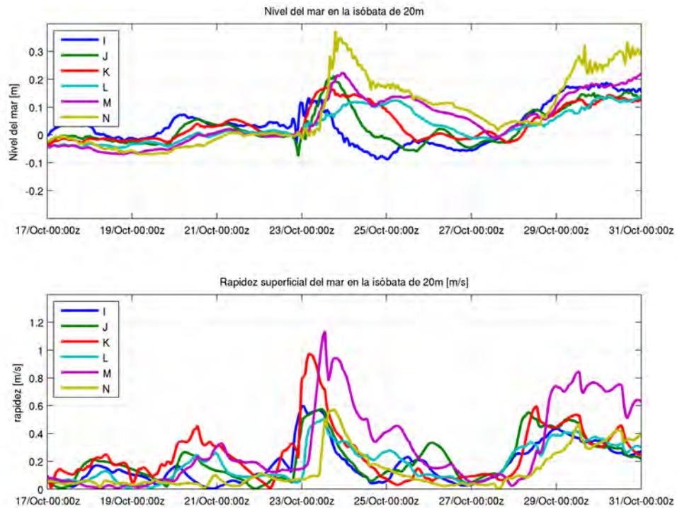
**Figura 6.13:** Serie de tiempo de los puntos I - N sobre la isobata de 20 metros en el nivel del mar. La mayor amplitud ocurre en el punto N, con casi 40 centímetros, en cambio la mayor velocidad se da en los puntos K y M
