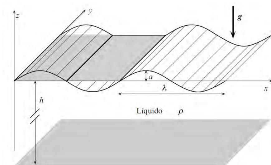
**Figura 4.1:** Diagrama de la propagación de una anomalía sobre una superficie con una velocidad de propagación  $v = \frac{\Delta x}{\Delta t}$ .
