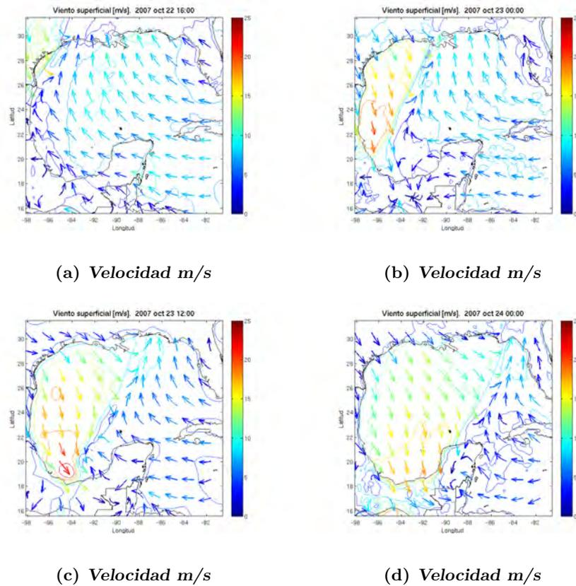
**Figura 6.1:** Viento WRF en superficie, a) 22 oct. 1600Z, rapidez máxima de los vientos 20.3 m/s (73.1 km/h), b) 23 oct. 0000Z, rapidez máxima de los vientos 22.5 m/s (81 km/h), c) 23 oct. 1200Z, rapidez máxima de los vientos 27.6 m/s (99.6 km/h), d) 24 oct. 0000Z, rapidez máxima de los vientos 20.7 m/s (74.6 km/h).
