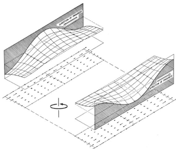
**Figura 4.6:** (10). “Ondas Kelvin en el hemisferio norte sobre lados opuestos de un canal el cual es comparada con el radio de Rossby, la superficie de elevación varía exponencialmente con la distancia de la costa en orden para dar un balance geostrofico”
