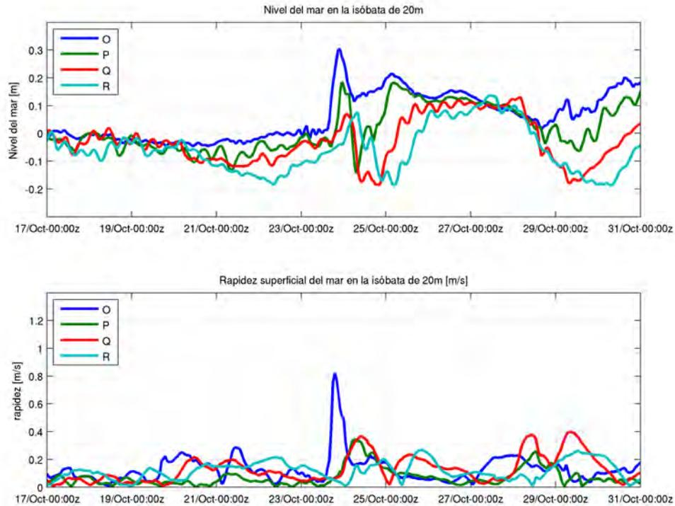
**Figura 6.14:** Serie de tiempo de los puntos O - R sobre la isobata de 20 metros en el nivel del mar. En los 4 puntos se observa el paso de la OAC y con mayor amplitud en los puntos O y P. La rapidez máxima se da en el punto O.
