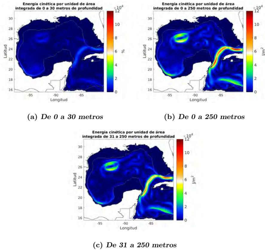
**Figura 6.33:** Energía cinética por unidad de área integrada en profundidad de los procesos asociados a todas las frecuencias (oscilaciones inerciales + flujo medio) para el período del 22/10 18:00z al 26/10 12:00z de 2007
