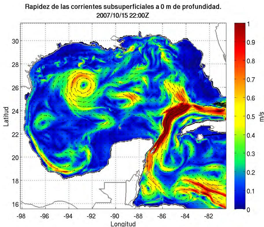
**Figura 6.15:** Rapidez superficial del GoM para el día 15 de octubre a las 22:00Z. Se observa que la corriente sobre la plataforma continental es paralela a la costa con sentido hacia el sur y la existencia de una corriente perpendicular a la costa en la zona de la Bahía de Campeche.
