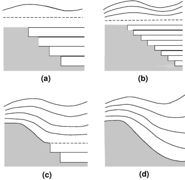
**Figura 5.3:** Diferentes combinaciones de malla vertical. a) un nivel  $\sigma$  en superficie sobre toda la columna  $Z$ ; b) Para poder analizar los cambios en la superficie se utilizan algunos niveles  $\sigma$  en los primeros metros y el resto niveles  $Z$ ; c) En regiones de aguas someras se usan niveles  $\sigma$  y en aguas profundas niveles  $Z$ ; d) Niveles  $\sigma$  para toda la malla vertical, desde superficie hasta el fondo.
