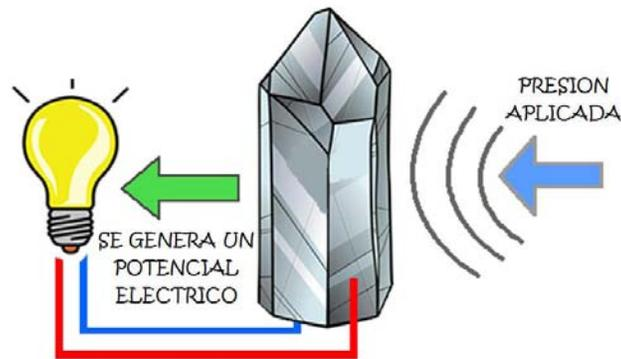
*Fig1.4 Efecto Piezoeléctrico en un cristal*
