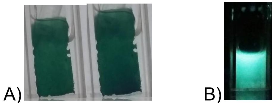
Figura 21. A) Película de PFCbz sobre ITO: izquierda con E = -0.3 V y derecha con E = 1.7 V. B) Película de PFCbz sobre ITO en \text{CH}_3\text{CN} bajo absorción de luz UV.
