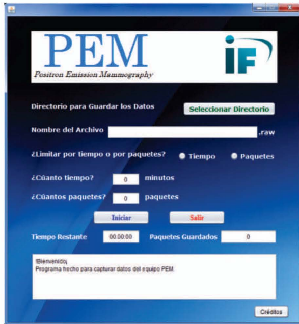
Figura 3.2: Captura de pantalla del software hecho para capturar y guardar la información proveniente del ADC para el prototipo de PEM.
