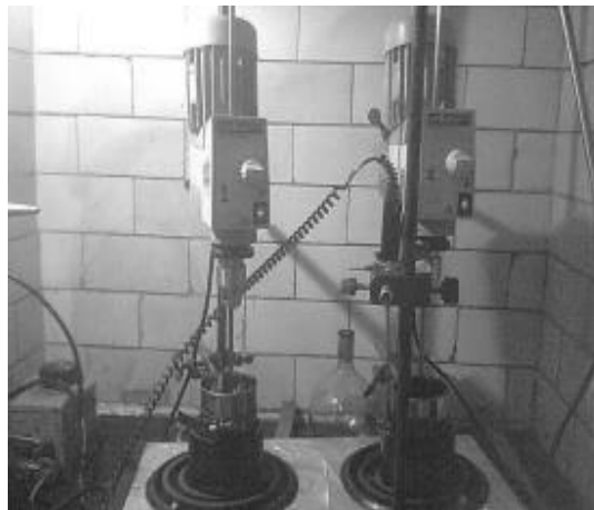
Figura 11. Montaje doble para la modificación de asfaltos.
