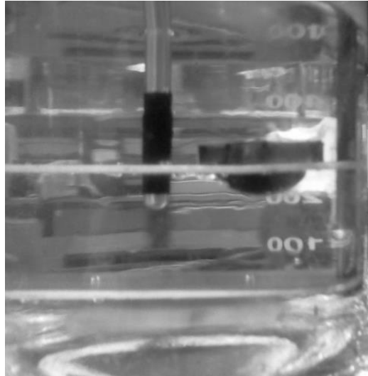
Figura 16. Inicio de la deformación de la mezcla asfáltica en la prueba de Temperatura de ablandamiento.
