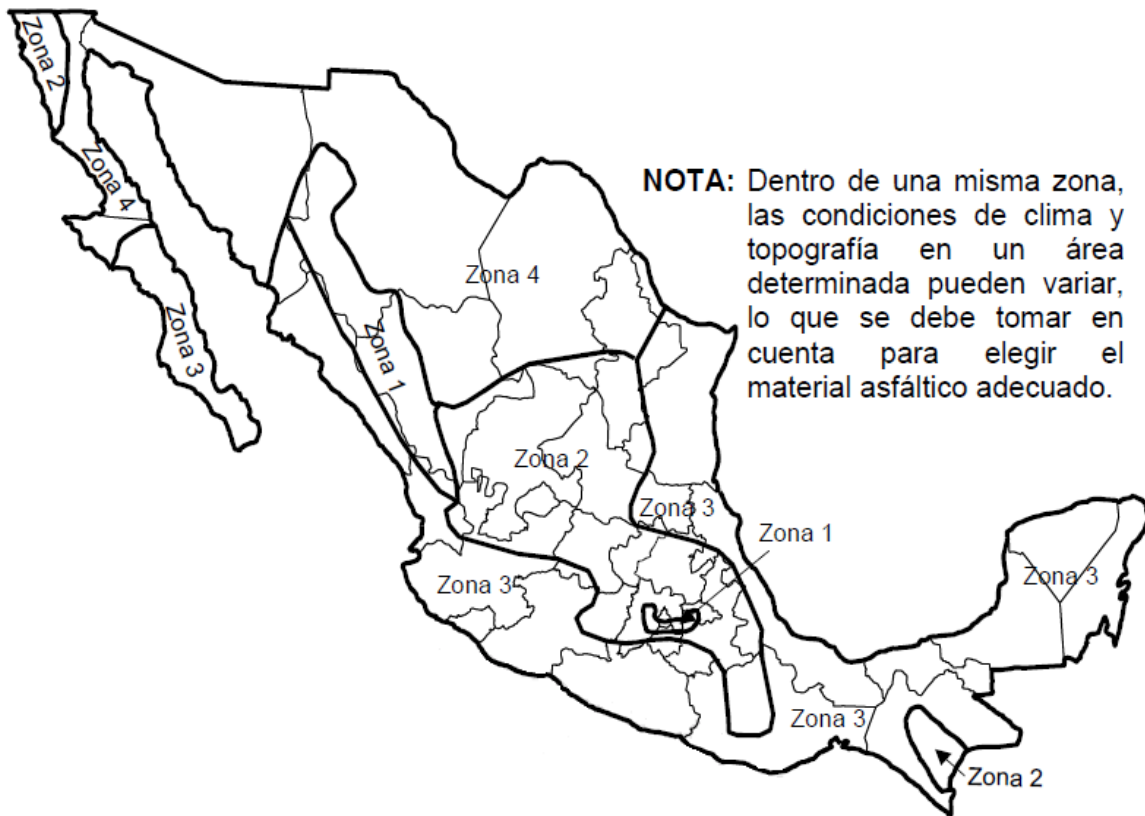
Figura 1. Regiones geográficas para la utilización de asfaltos clasificados según su viscosidad dinámica a 60 °C [3].
