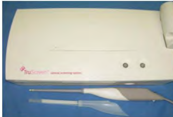
Fig. 1. TruScreen. TruScreen es un sistema portátil que consta de una consola y una sonda en forma de bolígrafo. El tamaño de la consola es 38 \times 19 \times 7 cm y la longitud de la tapa desechable es de 25 cm.
