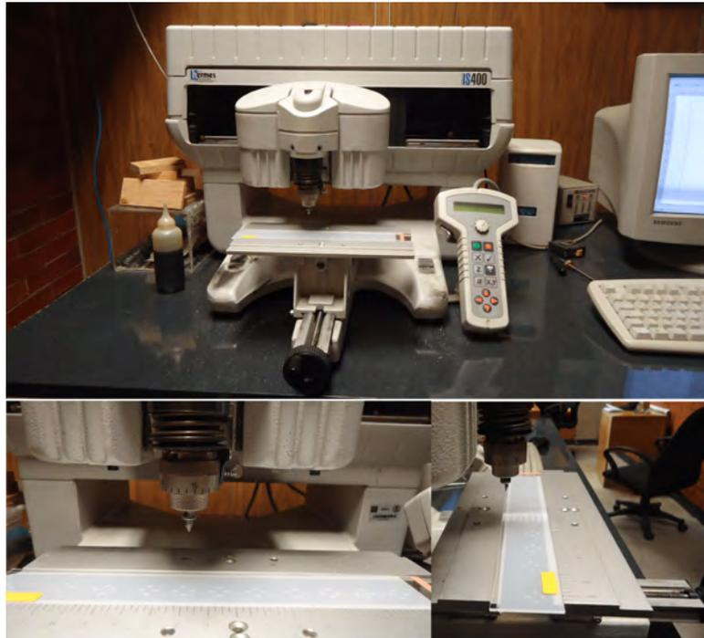
**Figura 7.7:** Máquina CNC.
