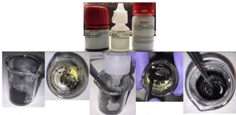
**Figura 7.2:** Preparación de pasta conductora sensibilizada con GOx.
