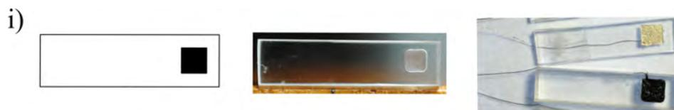
**Figura 8.10:** Diseño i). Electrodos de  $(2.0 \times 2.0\ \text{mm} \pm 500\ \mu\text{m})$  de área  $\times$   $(700\ \mu\text{m} \pm 200\ \mu\text{m})$  de profundidad, elaborados en PMMA con maquinado CNC para una medición. Se muestra diseño, molde en acrílico y electrodos, de trabajo (pasta de rodio en carbón) y de referencia (plata).
