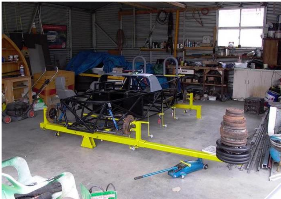
Fig. 1-16 Banco de pruebas mediante pesas [26]
