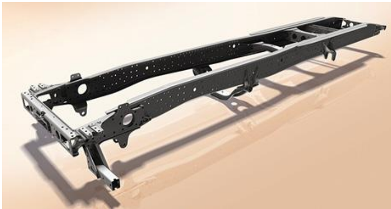
Fig. 1-2 Chasis formado por largueros y travesaños [12]
