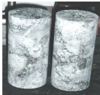
Fig. 1.2. Roca intacta de 100 mm. de diámetro por 200 mm. de largo en una brecha de la mina conocida con el nombre: El teniente en Chile. 19
