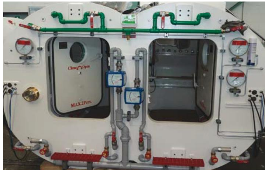
Fig. 3.6. Ejemplo de cámaras Hiperbáricas de una TBM. 77
