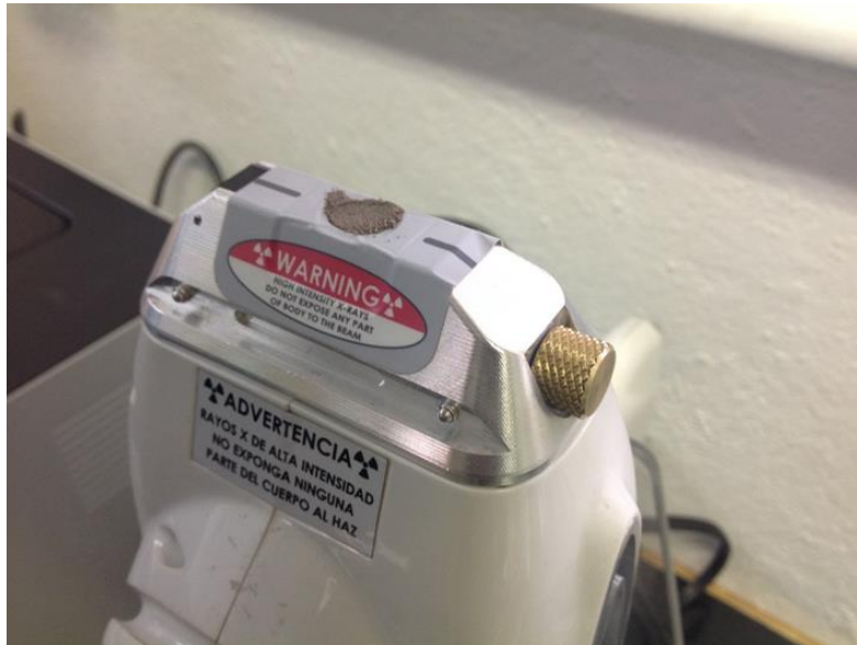
Figura 185. Porción de sedimento sobre la ventana de proleno del analizador
