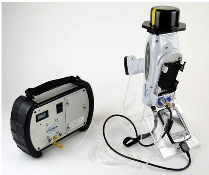
Figura 184. Tracer marca Bruker© y bomba de vacío
