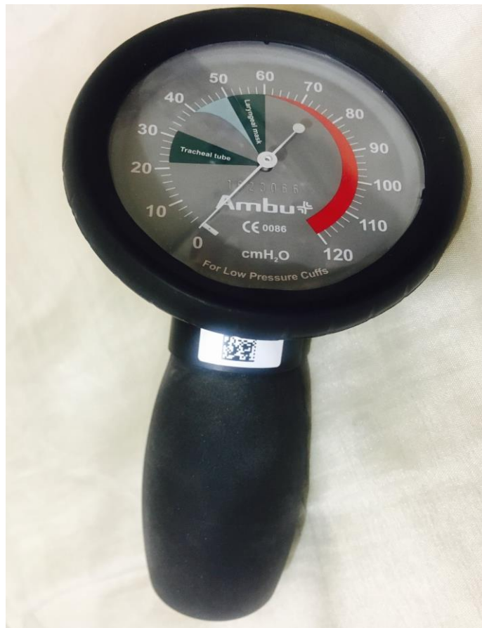
Figura 4. Manómetro aneroide. Fotografía de Myriam Liliana Cid Barreras.
