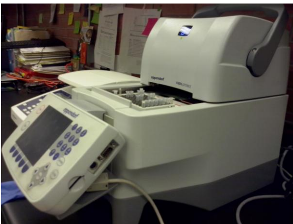
Figura 4: Termociclador Eppendorf vapo.protect® antes de iniciar PCR experimental
