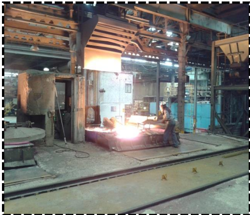
A-11. Horno de fundición, donde la mezcla de metales es preparada a ciertas temperaturas para su posterior proceso.
