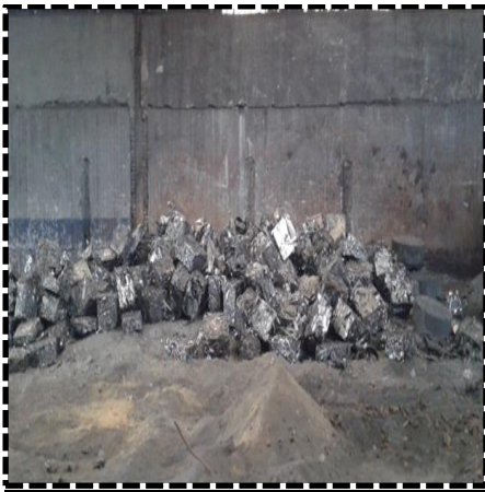
A-7. Chatarra de acero, es la materia prima para el proceso de fabricación de las piezas.
