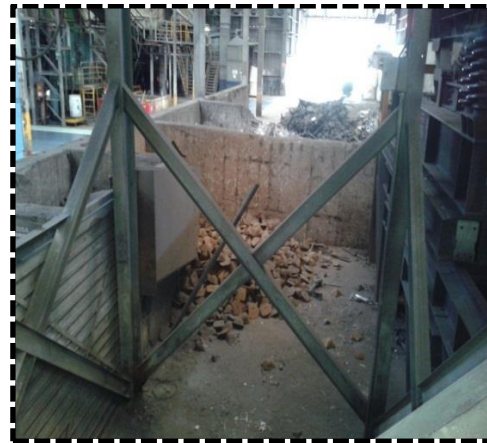
A-8. Arrabio (sorel). Obtenido de la primera fusión del hierro en los hornos.
