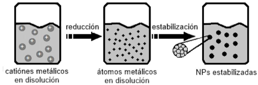
**Esquema 18. Formación de NPs vía reducción de sales metálicas**
