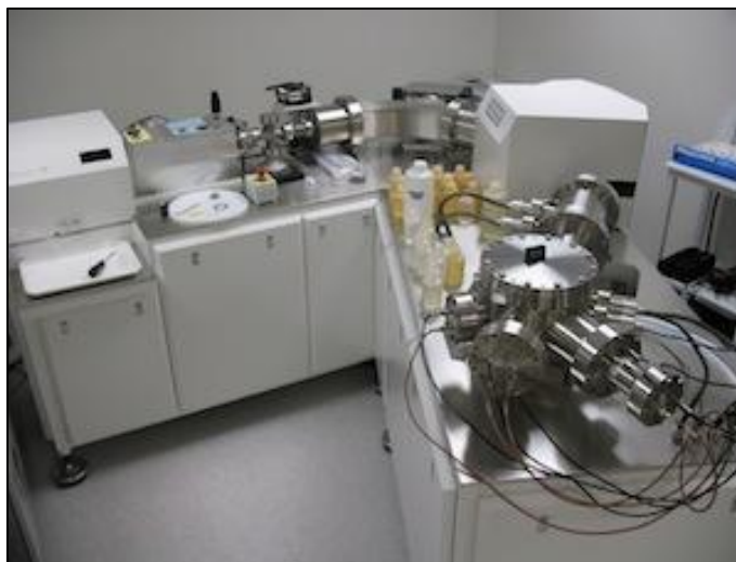
Figura 4.6 Espectrómetro de masas con plasma ( Nu Plasma LA-MC-ICP-MS ) empleado por el Arizona LaserChron Center para los fechamientos de las muestras mediante U-Pb en zircones.
