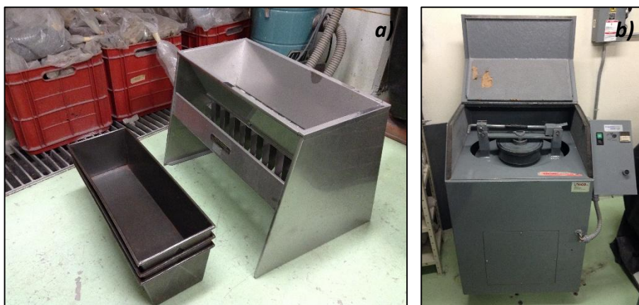
Figura 4.2 a) Cuarteadora metálica empleada para el cuarteo y obtención de dos alícuotas de ~ 100 gr cada una por muestra; b) pulverizadora con recipiente y discos de acero endurecido empleada en este estudio.
