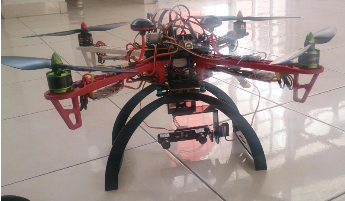
Figura 70. Cuadricóptero con la implementación del sistema de visión estereoscópica. El sistema se diseñó para ser implementado en un VANT; principalmente en un cuadricóptero.
