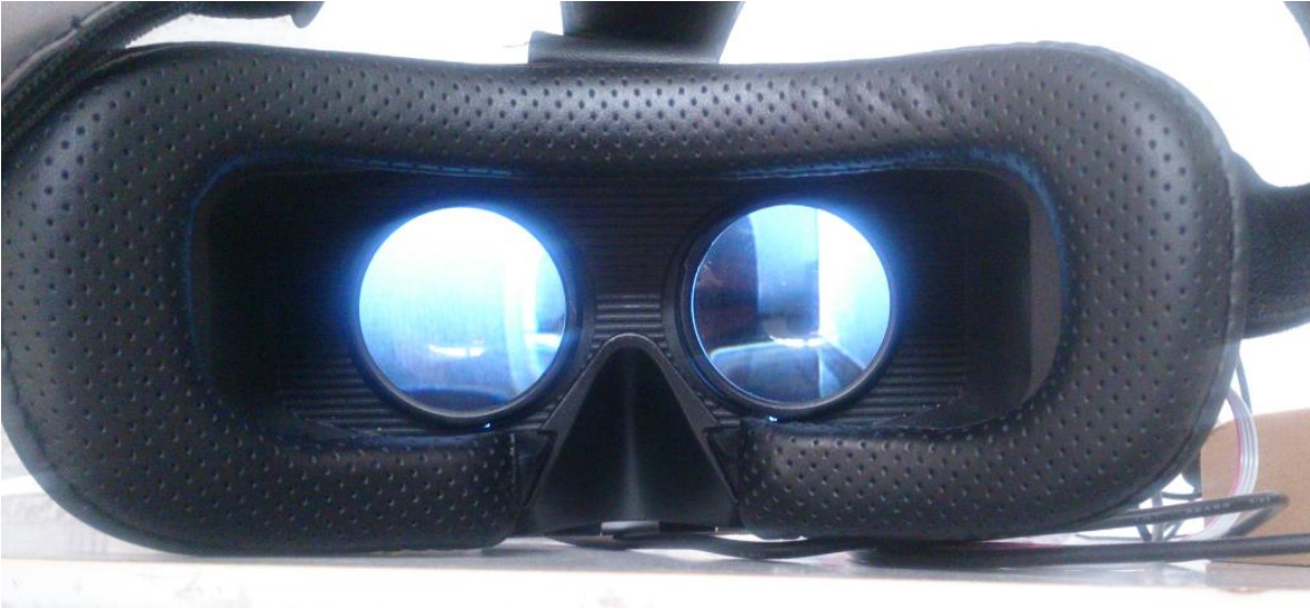
Figura 74. Estereoscopia a través del visor de realidad virtual. La imagen estereoscópica se presenta de forma aislada a cada ojo, mediante el visor de realidad virtual.
