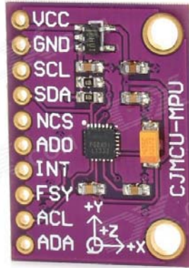
Figura 34. Módulo CJMCU-MPU, IMU de 9 ejes [58].
