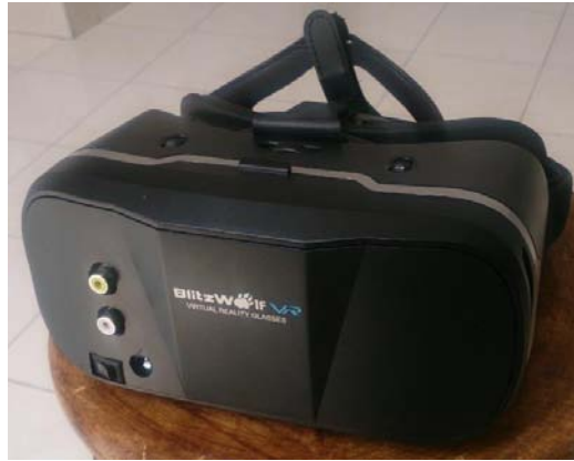
Figura 64. Acabado del visor de realidad virtual construido. El visor cuenta con entradas de audio y video, así como de alimentación de 12 V. El visor posee una salida de audio para audífonos. Este visor permite el ajuste de la distancia interpupilar, al igual que ajustes de la distancia focal para cada ojo.
