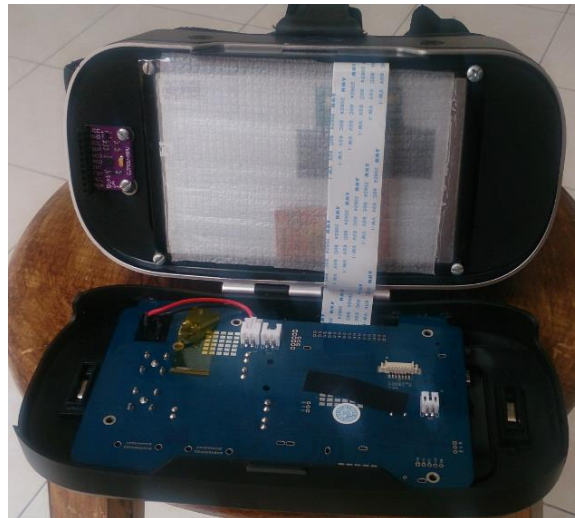
Figura 65. Sustitución del smartphone, por una pantalla de 5 pulgadas. Al colocar una pantalla de 5 pulgadas, el visor admite una señal de video analógico, que debe ser procesada previamente, para que esta se visualice correctamente por cada ojo.
