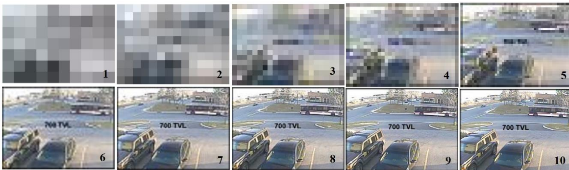
Figura 26. Imágenes utilizadas para el experimento para determinar la mínima resolución.
