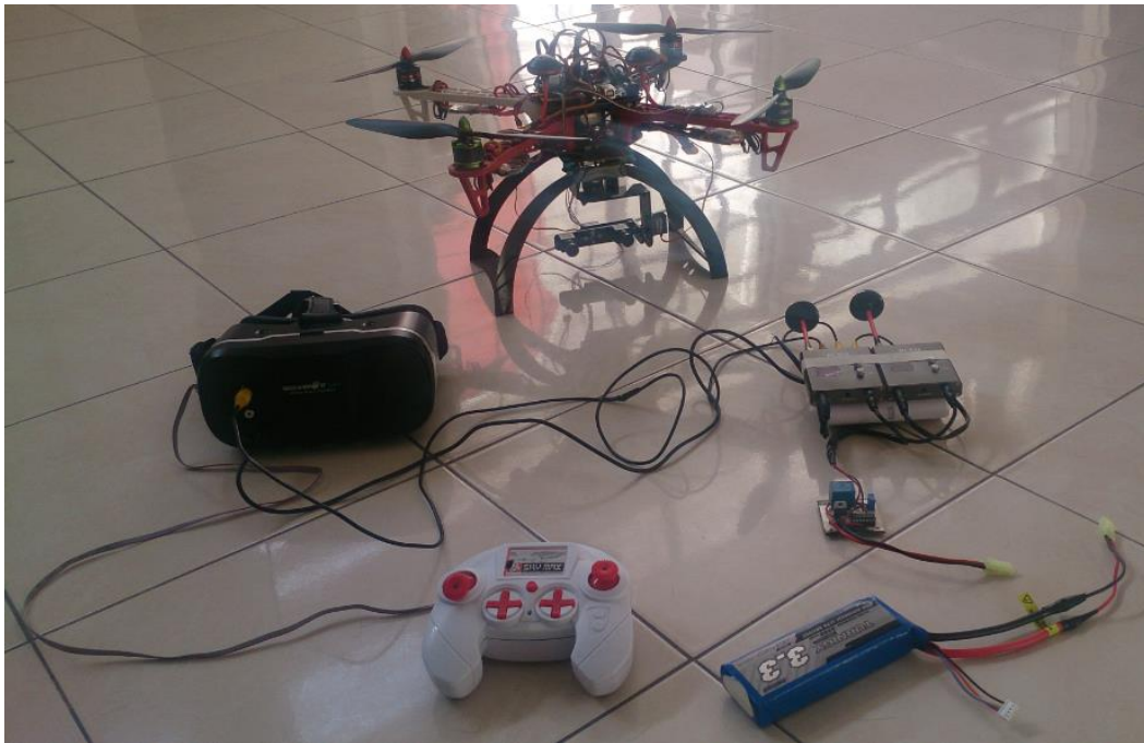
Figura 71. Sistema completo de visión estereoscópica, implementado sobre un cuadricóptero. En la imagen se observa la interconexión entre los dispositivos, que también se encuentra descrita por el diagrama del apéndice.
