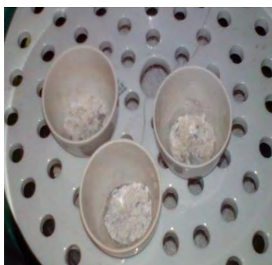
Figura 9. Crisoles con muestra calcinada en mufla a 550°C.
