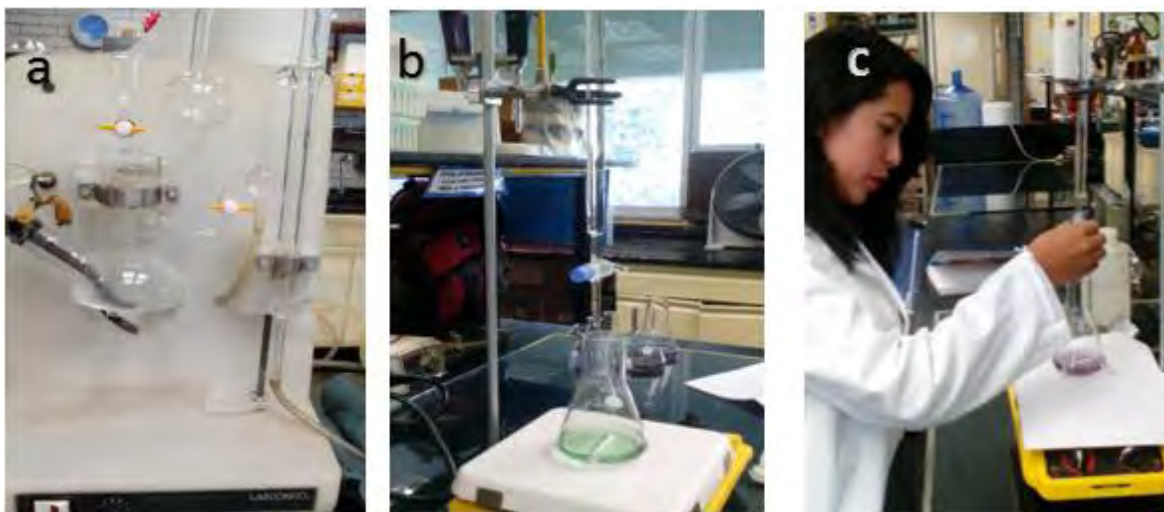
Figura 17. a) Destilador Micro-Kjeldahl, b) Mezcla digerida lista para valorarse y c) Solución valorada.
