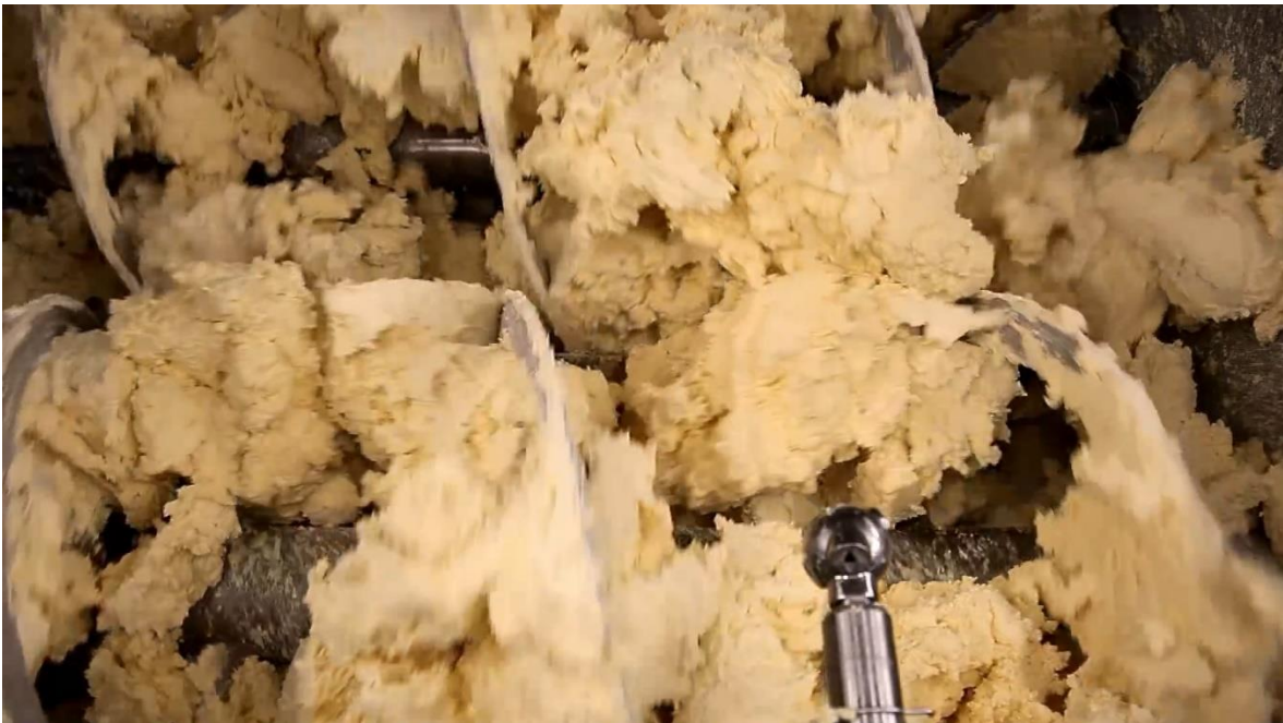
Figura 12. Mezclador de doble cinta. Línea de Producción de Queso procesado (KARL SCHNELL, 2013).
