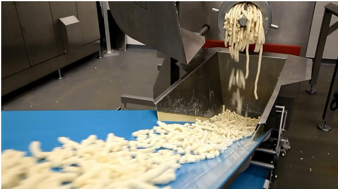
Figura 11. Queso molido siendo transportado a la mezcladora. Línea de Producción de Queso procesado (KARL SCHNELL, 2013).
