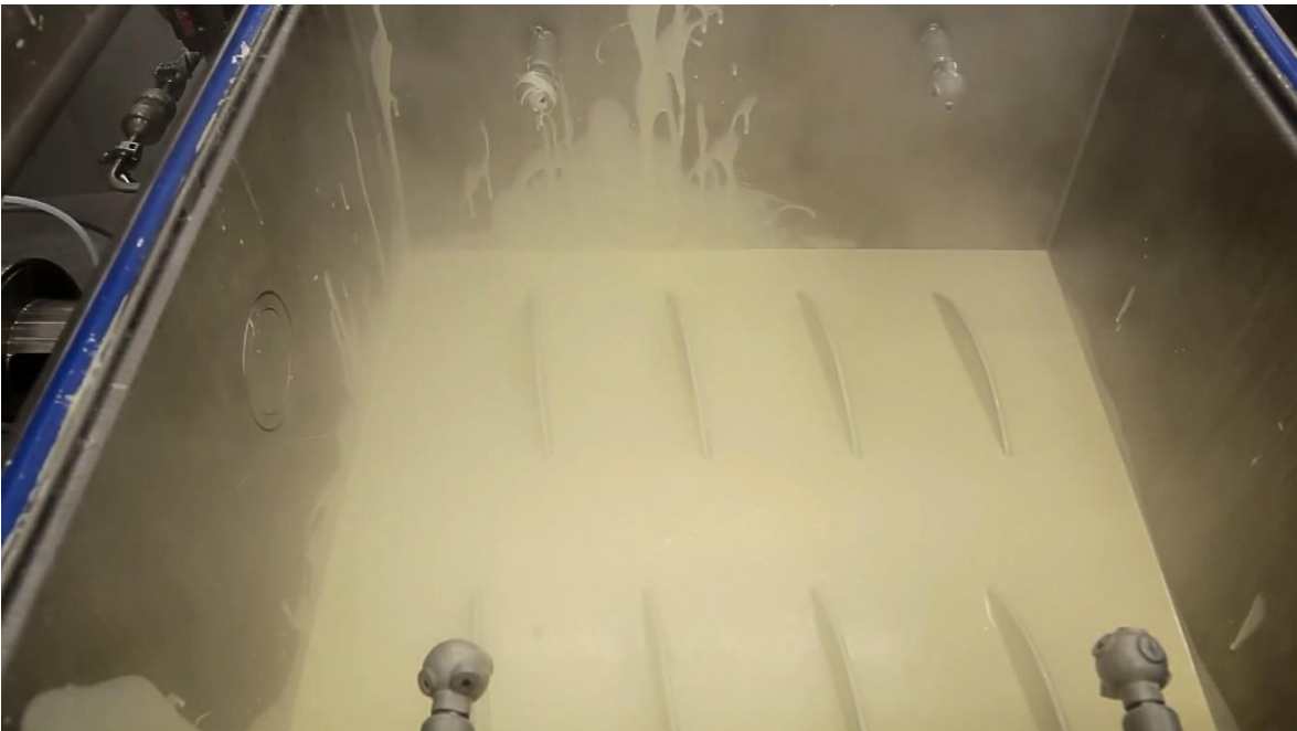
Figura 13. Tina de cocción por lote con inyección de vapor. Línea de Producción de Queso procesado (KARL SCHNELL, 2013)
