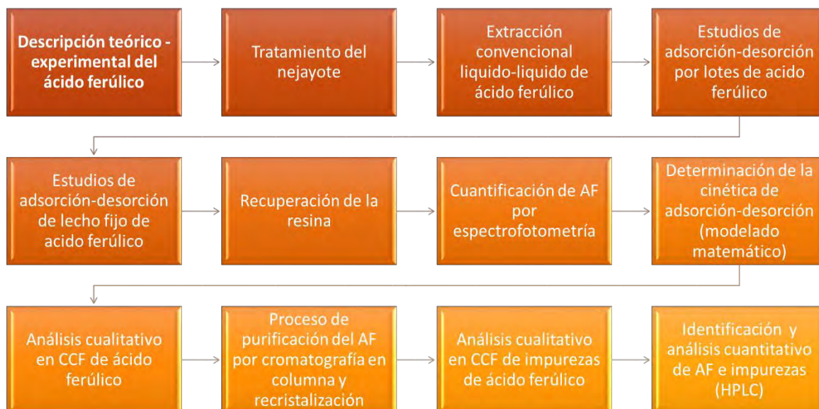
Figura 26. Procedimiento teórico-experimental en la obtención de ácido ferúlico.
