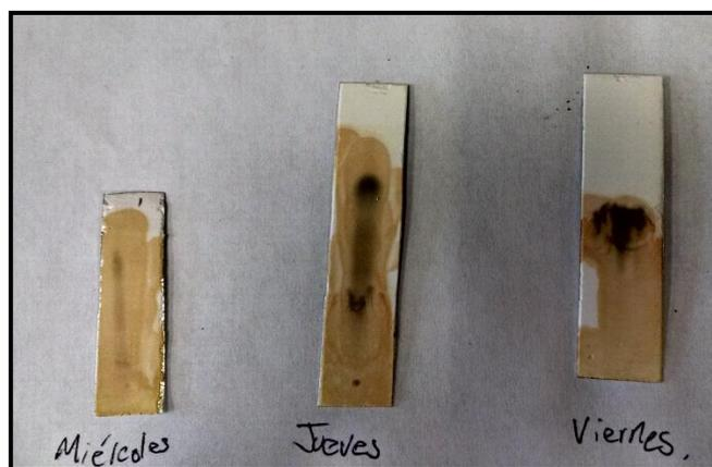
Figura 9 – Extracto hidroalcohólico preparado por maceración y revelado con yodo 0, 24 y 48 horas después de su preparación.
