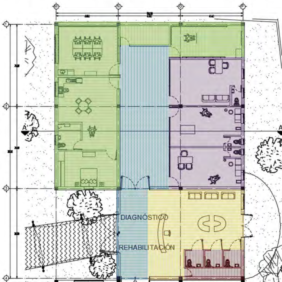
Planta Arquitectónica del Edificio de Diagnóstico, donde se muestra la zonificación por medio de colores.
