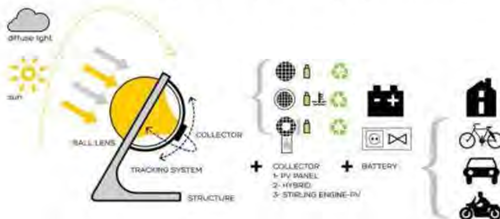
Imagen que resume el funcionamiento de los paneles solares esféricos.
