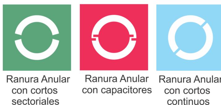
Figura 2.4. Configuraciones de cargas para el elemento radiador
