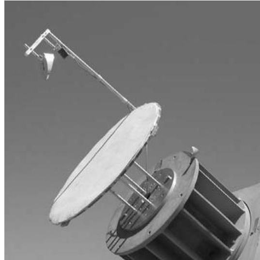
Figura. 1.30. Arreglo Cassegrain con offset de alimentación de 0.75 [m] para la banda dual X/Ka [81].
