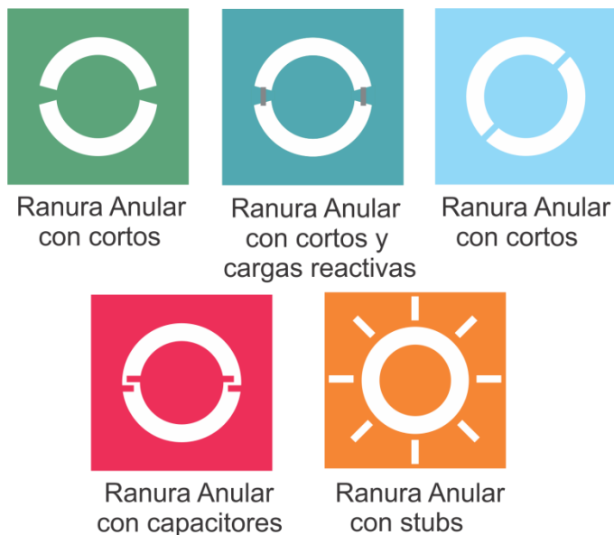
Figura 1.18. Celdas para RA tipo espirafase basados en ranuras anulares
