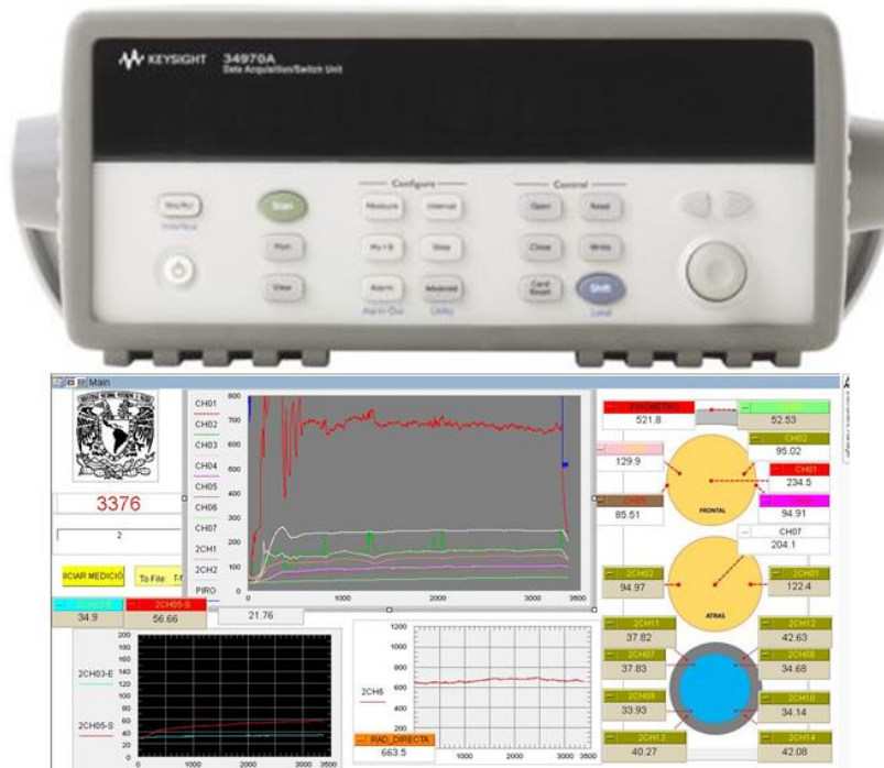
Figura. 3.10: Adquisidor de datos modelo 34970A (superior), sistema esquemático de la captura de datos (inferior)
