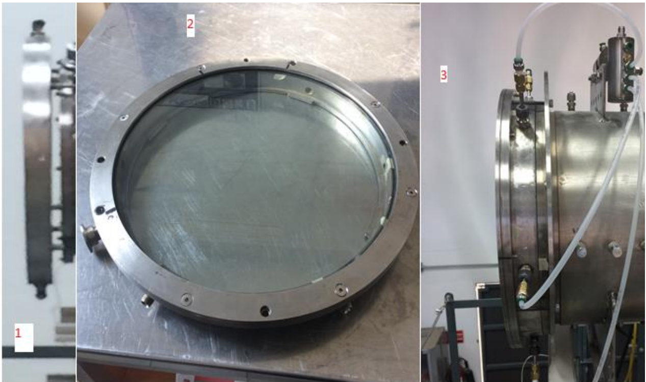
Figura 3.4: Sistema esquemático de la apertura del reactor solar (1) escudo refrigerado, (2) Brida de la ventana y (3) brida de entrada de gases.
