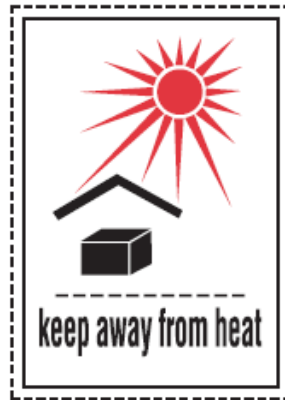
Figura 5.5. 7 Etiqueta para paquetes que deben mantenerse alejados del calor, esta etiqueta debe usarse en adición a las etiquetas de peligro que apliquen en los paquetes y sobre embalajes que contengan sustancias de la división 4.1 y división 5.2. Las dimensiones mínimas son de 74x105mm.
