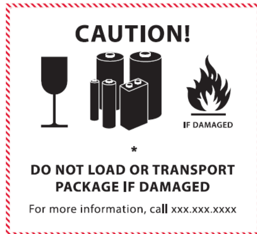
Figura 5.5. 9 Etiqueta para los paquetes que contienen baterías de litio y que cumplen con los requisitos de la sección II de las instrucciones de empaque (965 – 970) de la IATA. Las dimensiones mínimas deben ser de 120x110mm.
