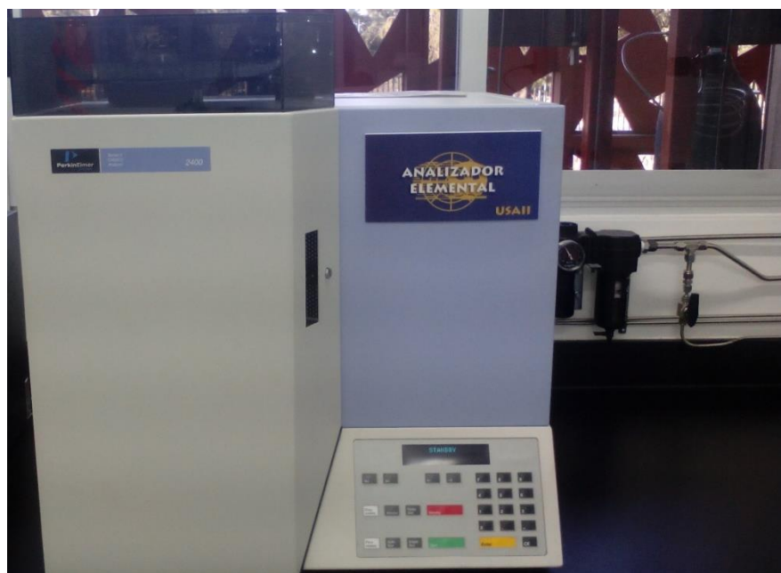
Figura 8. Analizador elemental CHNS/O 2400 Serie II Perkin Elmer empleado en el análisis de nitrógeno en este trabajo.
