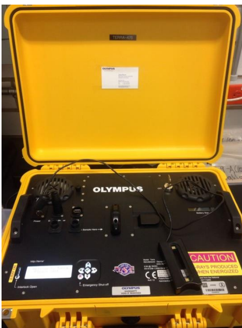
Figura 5. Difractómetro portátil marca Olympus modelo Terra 476 utilizado para el análisis mineralógico.
