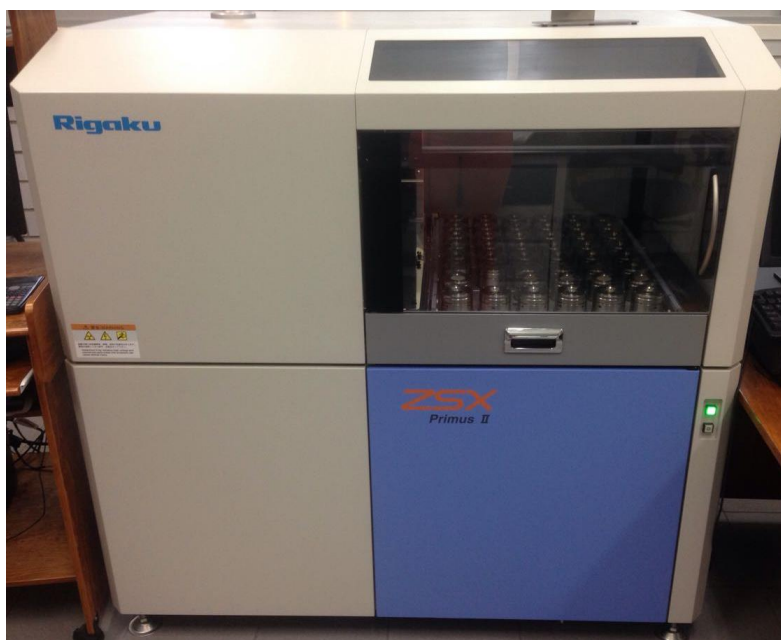
Figura 6. Espectrómetro secuencial de rayos X Rigaku Primus II utilizado para el análisis multielemental.
