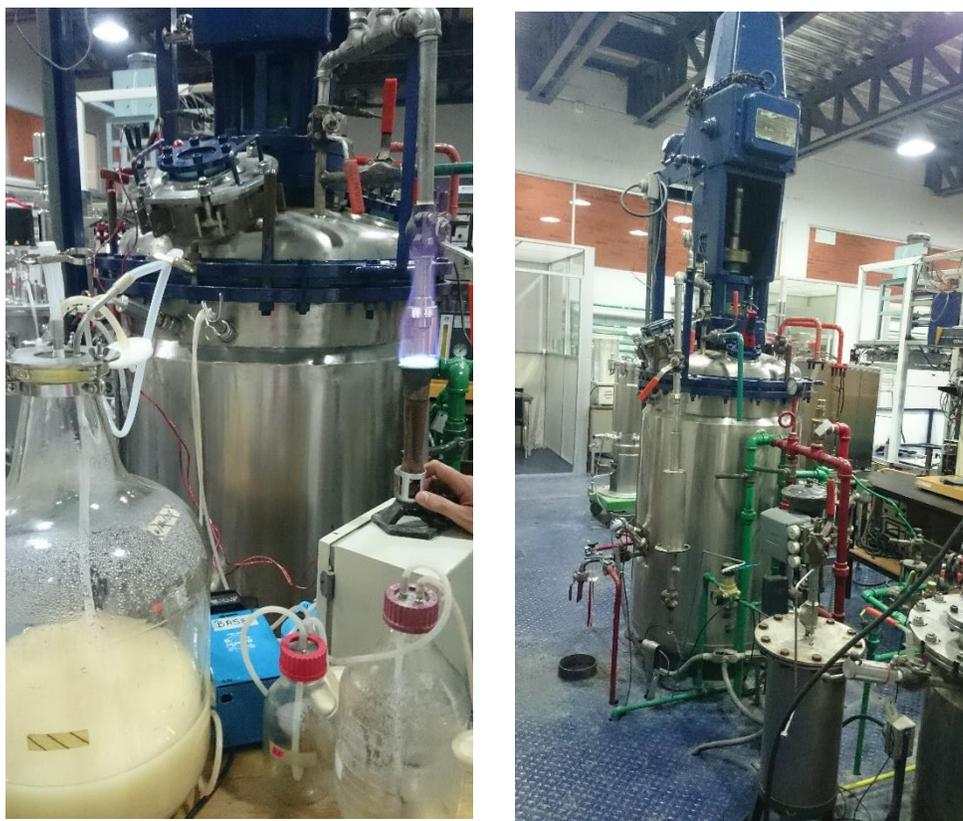
**Figura 3.2** Fermentador en el que se llevó a cabo el crecimiento a gran escala de la bacteria *Ga. diazotrophicus*.
