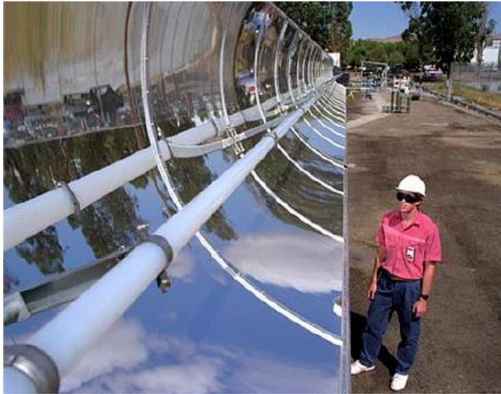
FIGURA #13 – Colector solar adaptado para fotocatálisis
