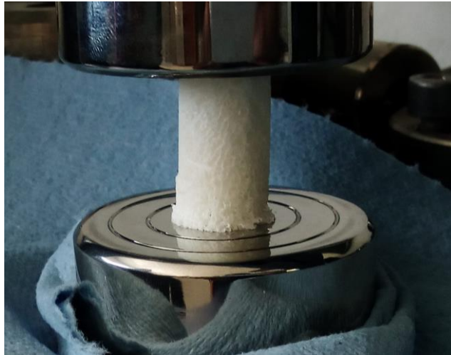
Fig. 12 Probeta de Nukbone® en medio de la realización de la prueba de compresión (izquierda), Fig. 13 La máquina Shimadzu® del Laboratorio de Pruebas Mecánicas del IIM (derecha).
