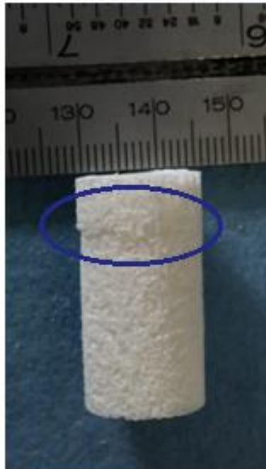
Fig.17 Probeta 1 después de la prueba de compresión, se nota una gran fractura, que involucra a muchas trabéculas.
