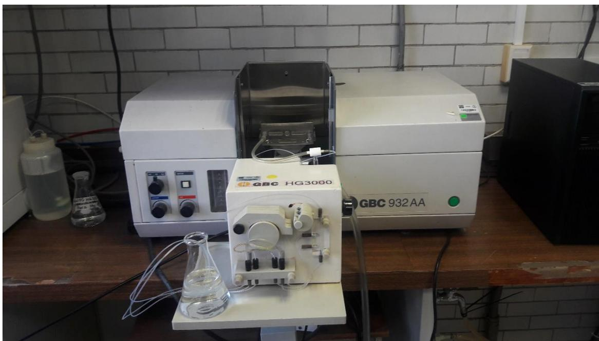
**Figura 22** Espectrofotómetro de absorción atómica acoplado a un generador de hidruros (EAA-GH)
