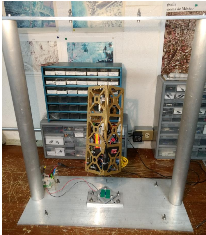
Fig. 2.4. Equipo de medición del centro de masa. El nanosatélite pende de uno de sus vértices. En este caso se trata de un nanosatélite estándar CubeSat 3U.
