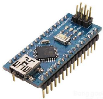
Fig. 2.13 Tarjeta de desarrollo Arduino nano, utilizada en esta aplicación, fundamentalmente por sus dimensiones reducidas.
