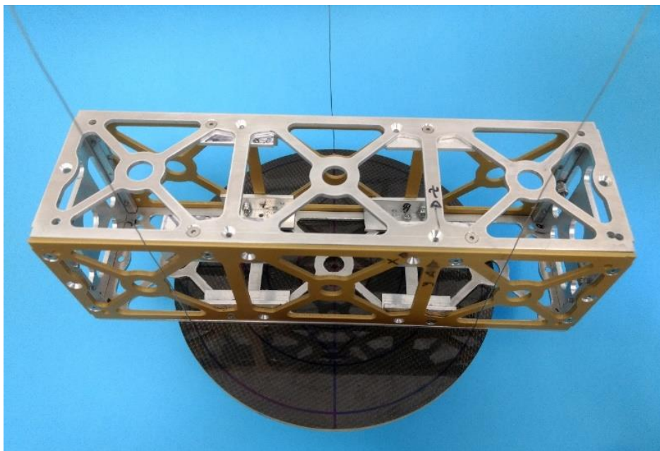
Fig. 5.1 Prueba de medición del momento de inercia con respecto al eje XX.
