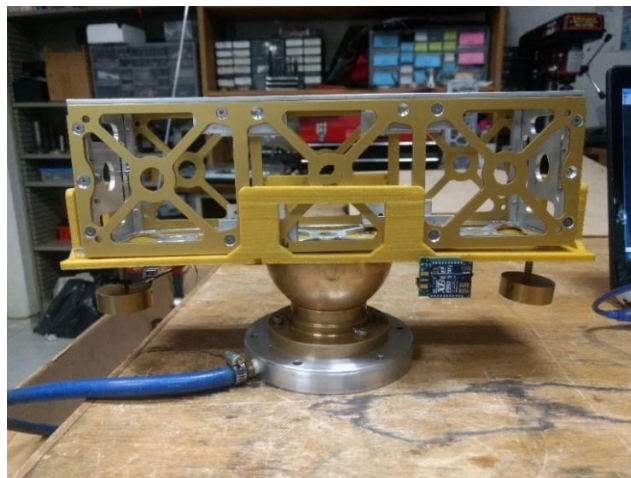
Fig. 2.6 Sistema diseñado y construido para determinar el centro de masa del nanosatélite.
