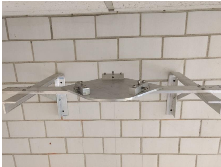
Figura 3. 6. Ménsulas y base de sujeción de los tres hilos de acero inoxidable del péndulo.
