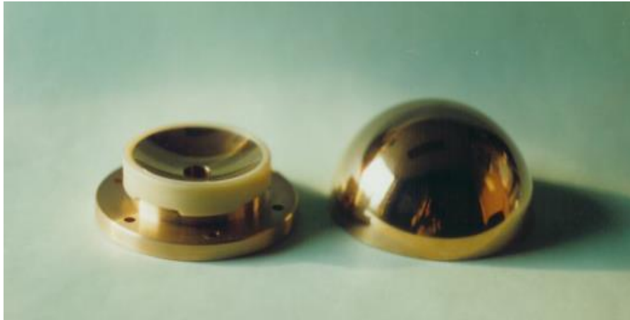
Fig. 2.7 Cojinete neumático esférico, compuesto de una copa que suministra aire a presión y una semiesfera.
