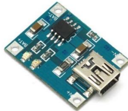
Fig. 2.17 Módulo cargador de baterías basado en el circuito integrado TP4056
