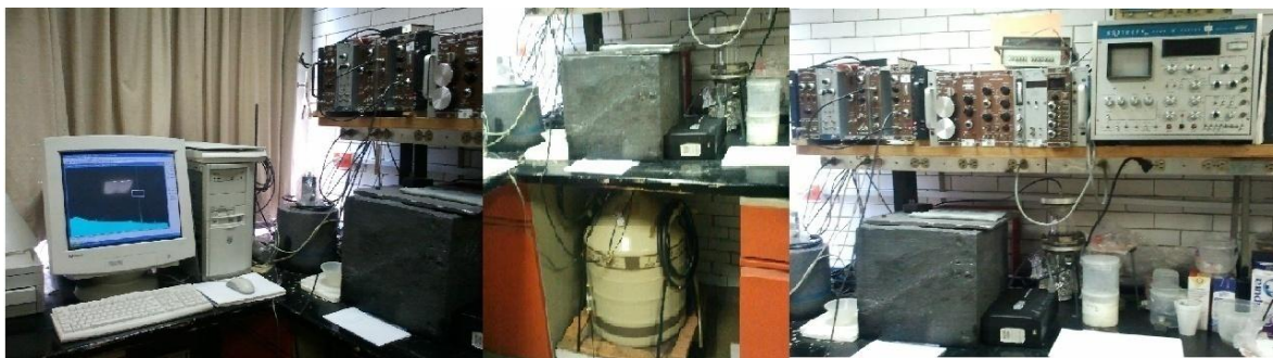
Figura xx. Detector utilizado de Germanio Hiperpuro.
