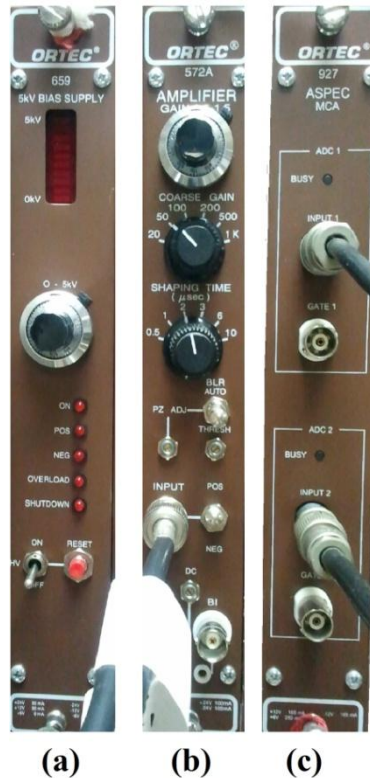
Figura xxiii. Sistema electrónico: Fuente de poder de alto voltaje (a), amplificador (b) y analizador multicanal (c).
