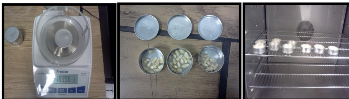
Figura 2.3. Determinación de humedad
