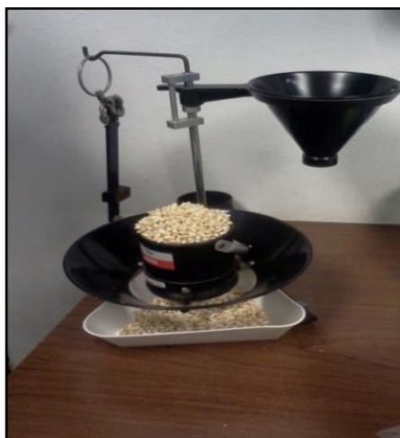
Figura 2.2 Balanza de peso hectolítrico marca OHAUS
