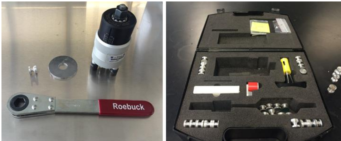
Fig. 2.20 Equipo “ELCOMETER Pull-Off 106”
