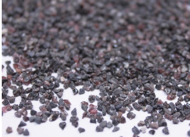
Fig. 2.4. Granalla oxido de Aluminio [12].
