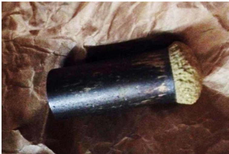
Fig. 2.7. Probeta acero de bajo carbono después de generar recubrimiento
