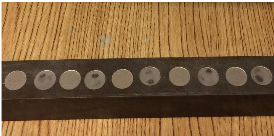
Fig. 2.23. Barra de acero utilizada para pruebas de electroerosión (huellas de trabajo).
