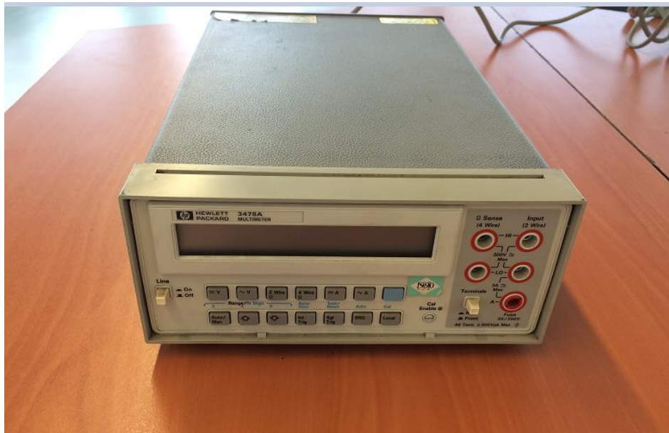
Fig. 2.22. Multímetro digital HP3478A
