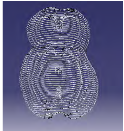
FIGURA 3.34 Curvas de nivel de la fase inicial de la tabicación este es el modelo que más singularidades y curvas abiertas este problema son debido a que no se tiene su tomografía y no se puede mejorar su nube de puntos
