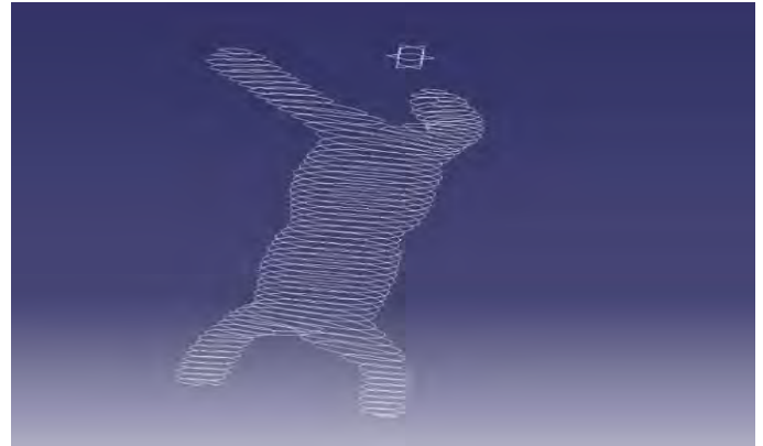
FIGURA 3.20 Curvas de nivel de la dilatación del tubo cardiaco en éste modelo sus curvas de nivel no tuvieron singularidades debido que se hizo una mejor obtención de su geometría antes de exportarlo a CATIA con ayuda de 3D slicer, aunque esto problema se debe a la resolución de la tomografía
