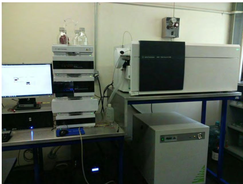
Figura 1.11 Cromatógrafo de líquidos de alta eficiencia acoplado a espectrómetro de masas, del laboratorio LUNA, CCADET, UNAM
