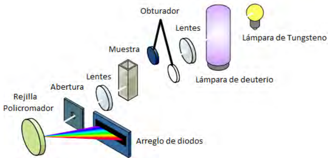
Figura 1.7 Instrumentación del detector de arreglo de diodos [83]
