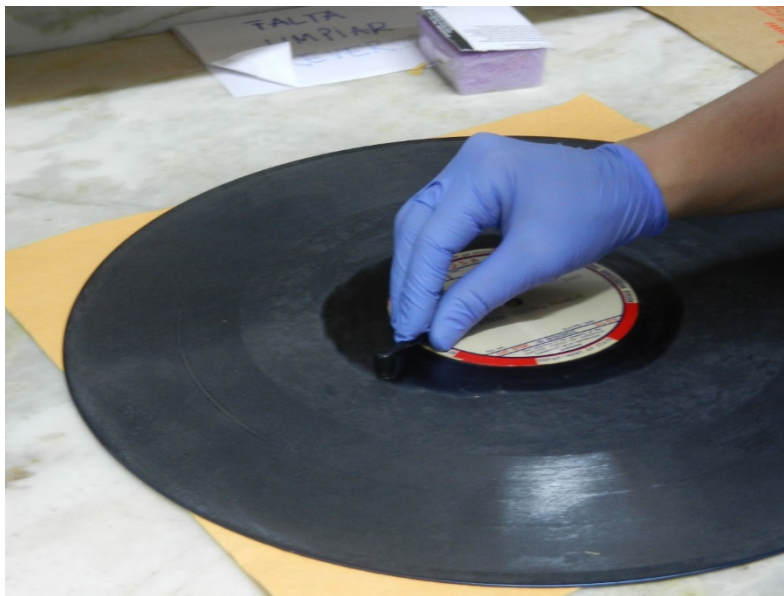
FOTO 15: LIMPIEZA DE ÁCIDO PALMÍTICO
