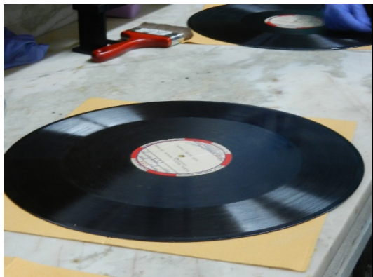
FOTO 24: DISCOS LIMPIADOS CON CEPILLO DE FIBRA DE CARBÓN.
