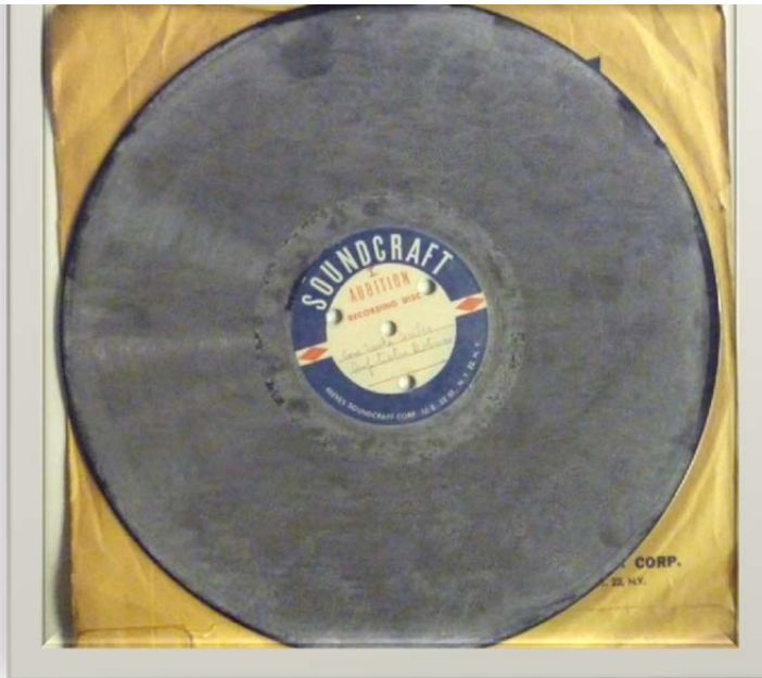
FOTO 22. DISCO DE ALUMINIO CON ÁCIDO PALMÍTICO Y ESTEÁRICO
