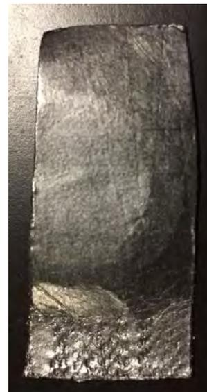
**Figura 44.** Contra electrodo, lámina de grafito
