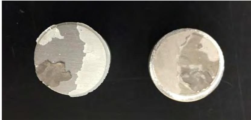
**Figura 62.** Segunda probeta sometida a la prueba de Pull – Off, en el lado izquierdo se encuentra el dollie con una capa de recubrimiento desprendida y del lado derecho la probeta con el recubrimiento desprendido del sustrato.
