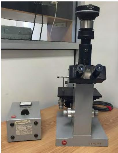
**Figura 35.** Microscopio óptico utilizado
