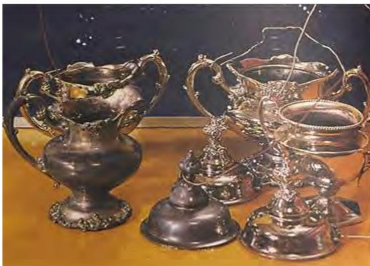
**Figura 6.** Objetos recubiertos por electrodeposición de níquel
