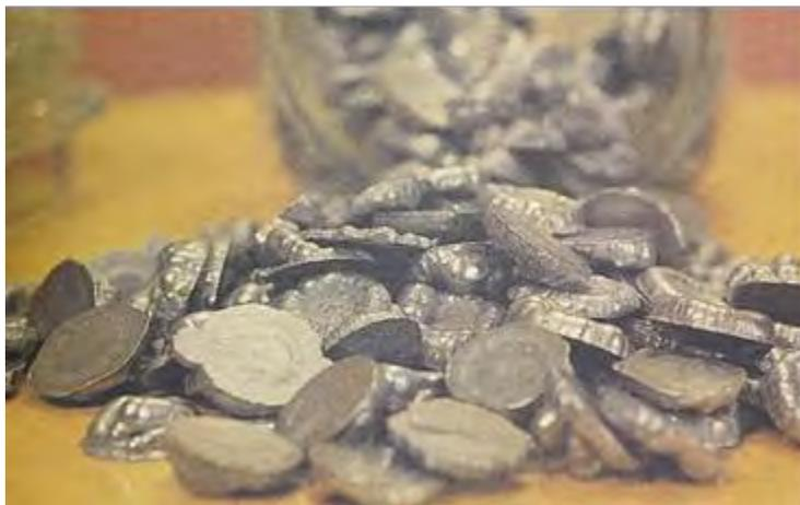
**Figura 5.** Pellets de níquel
