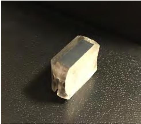
**Figura 37.** Probeta con la superficie con acabado espejo
