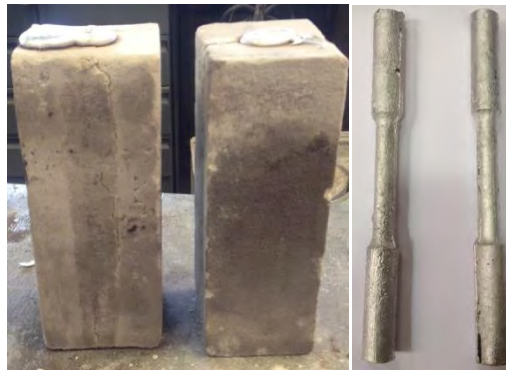
FIGURA 27. Probetas de tensión antes y después de desmoldar.
