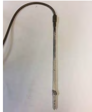
FIGURA 18. a) Sonda y b) Termopar
