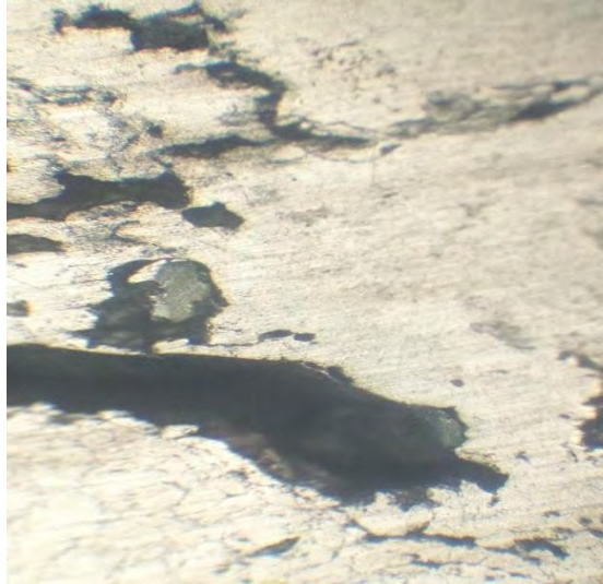
FIGURA 45. Metalografía de la probeta desgasificada en 12 minutos con escoria tomada en aumento de 100x.
