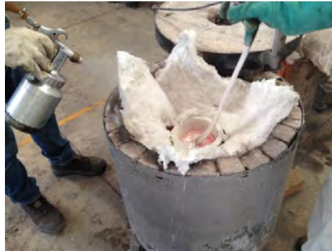
FIGURA 19. Gasificación de aluminio líquido en horno de quemadores a temperatura de 900^{\circ}\text{C} .
