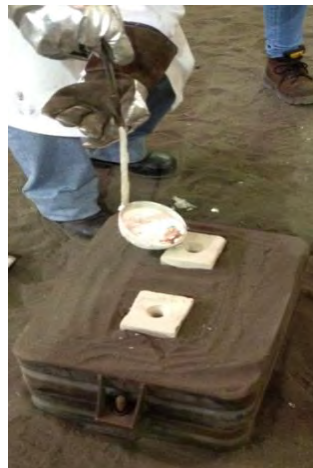
FIGURA 25. Vaciado de aluminio líquido gasificado en molde de probeta de tensión.
