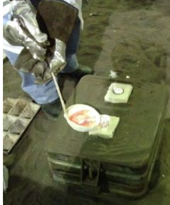
FIGURA 26. Vaciado de aluminio líquido desgasificado en molde de probeta de tensión.
