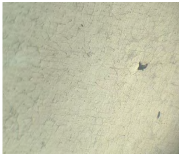
FIGURA 44. Metalografía de la probeta desgasificada en 12 minutos tomada en aumento de 100x
