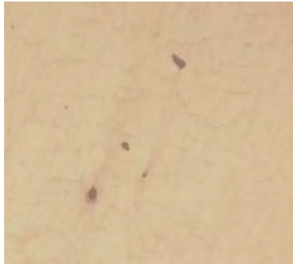
FIGURA 43. Metalografía de la probeta desgasificada en 7 minutos tomada en aumento de 100x.
