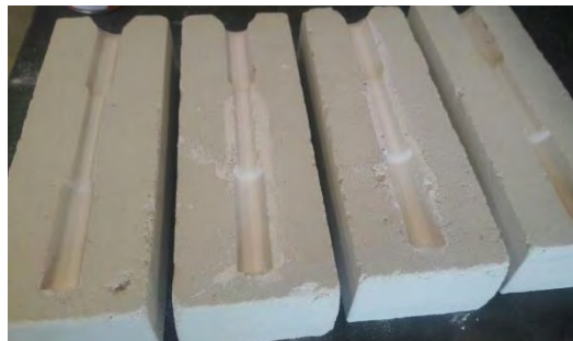
FIGURA 23. Moldes de silicato de sodio- \text{CO}_2 para obtener probetas de tensión.
