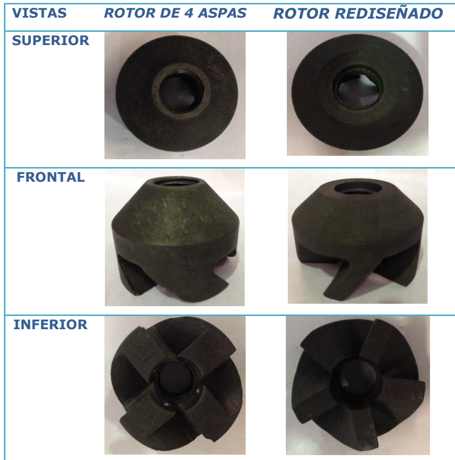
FIGURA 14. Rotores inyectoros utilizados para la prueba de desgasificación de aluminio puro comercial.
